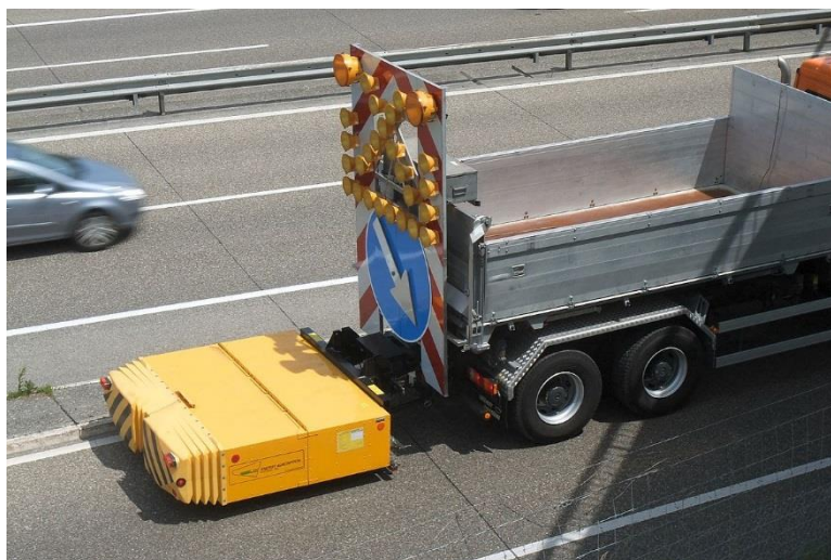
Figure 27 Exemple d'amortisseur d'impact de collision utilisé pour les travaux routiers 2
